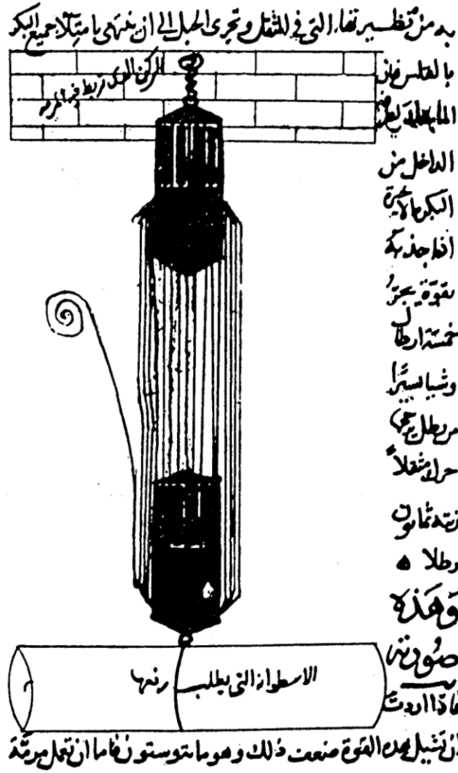
شكل (١٩) - تطبيق فكرة مجموعة البكرات لرفع جسم ثقيل بواسطة قوة يسيرة، كما وردت في مخطوط تقي الدين بن معروف المخطوط بمكتبة شستر بيتي بدبلن - رقم: ٥٢٣٢، صفحة ٢٨.
