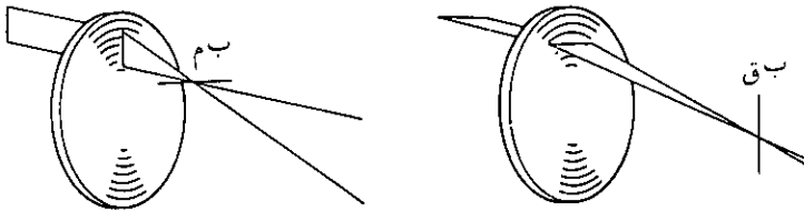
الشَّكْل ٩: تَتَجَمُّعُ الْحُزْمُ الضَّوئِيَّةُ فِي بُؤْرٍ مُخْتَلِفَةٍ تَبَعاً لِاتِّجَاحِهَا: الْبُؤْرَةُ التَّمَاسِيَّةُ إِلَى الْيَسَارِ وَالْبُؤْرَةُ الْقَطْرِيَّةُ إِلَى الْيَمِينِ.
